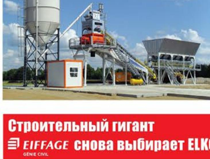
который будет обеспечивать производство 75 куб. м в час высококачественного бетона. Двухвалковый смеситель имеет объемом 2250/1500 л, склад цемента представлен двумя силосами по 75 тонн. По запросу заказчика завод будет укомплектован дополнительными устройствами безопасности.
